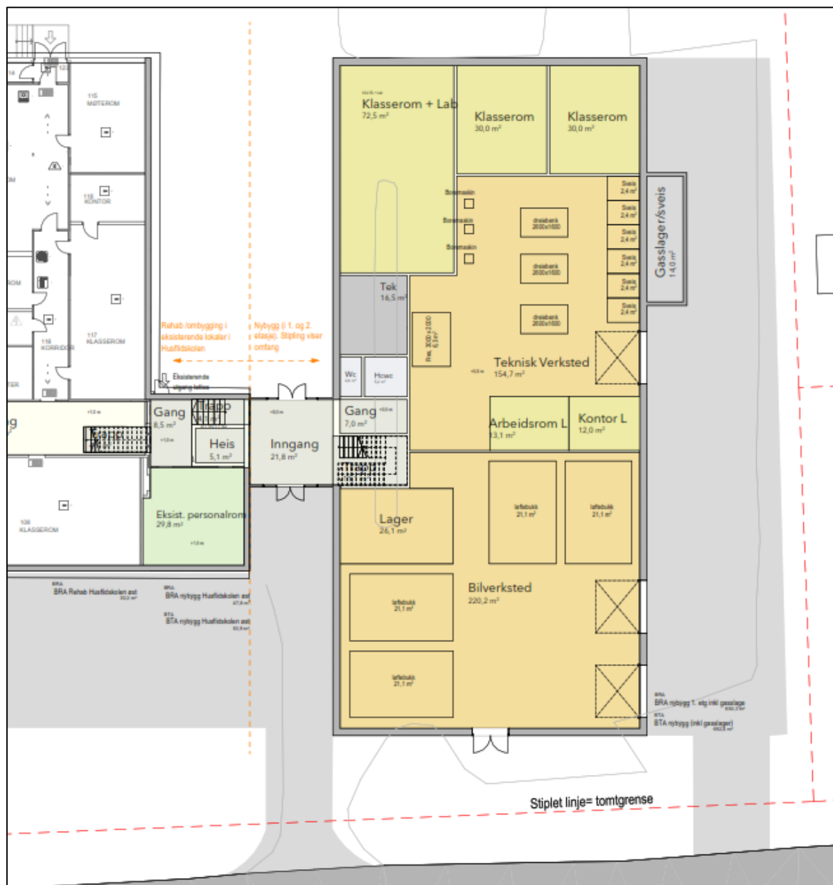
Figur 6 Foreløpig skisse av mulig planløsning i 1. etasje i nybygg, samt tilkoblingen til eksisterende bygg (Husflidskolen). Endelig romløsning ifm. med byggesak kan avvike fra dette. Utarbeidet av Asplan Viak.
