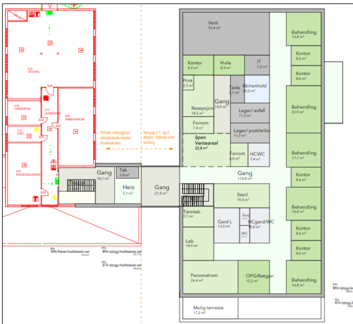
Figur 7 Foreløpig skisse av mulig planløsning i 2. etasje i nybygg hvor tannhelsetjenesten planlegges å holde til. Koblingen til eksisterende bygg (Husflidskolen) vises også. Endelig romløsning ifm. med byggesak kan avvike fra dette. Utarbeidet av Asplan Viak.
