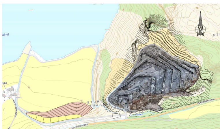
Figur 0-5 Dagens masseuttak til høyre, planlagt mellomlagring av masser til venstre. Kilde: Mibau Stema Norge
