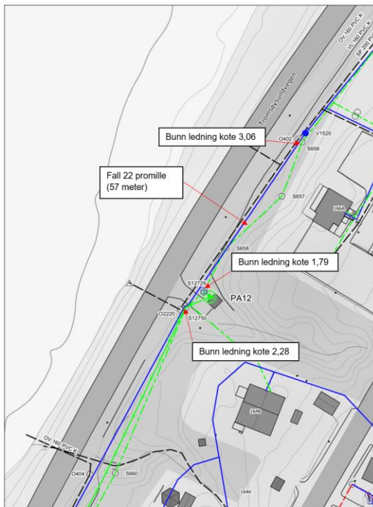
Figur 3.3.3 Høyder eksisterende ledninger ved PA12.
