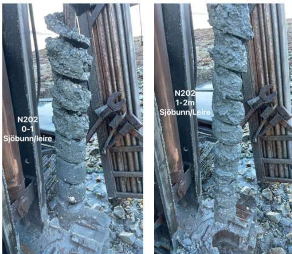
Figur 5: Utførte naverboringer ved N202
